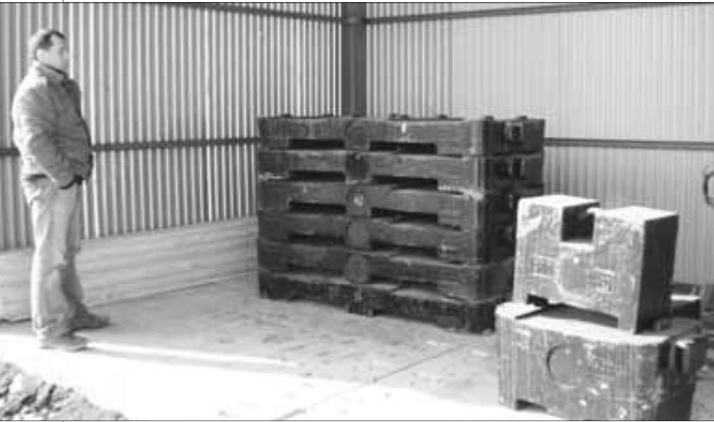
Odważniki o wadze 500, 1000 i 2000 kg, służące do skalowania wag
